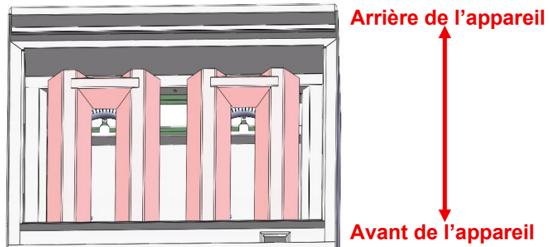
Figure A – Plaques radiantes correctement installées au-dessus des brûleurs.
