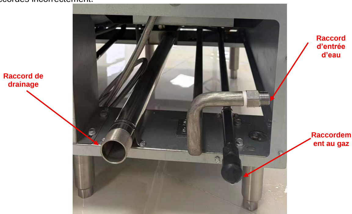
Figure A – Emplacements des raccords de service arrière
