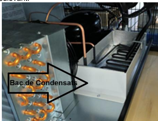
Image : Emplacement du bac de condensats
